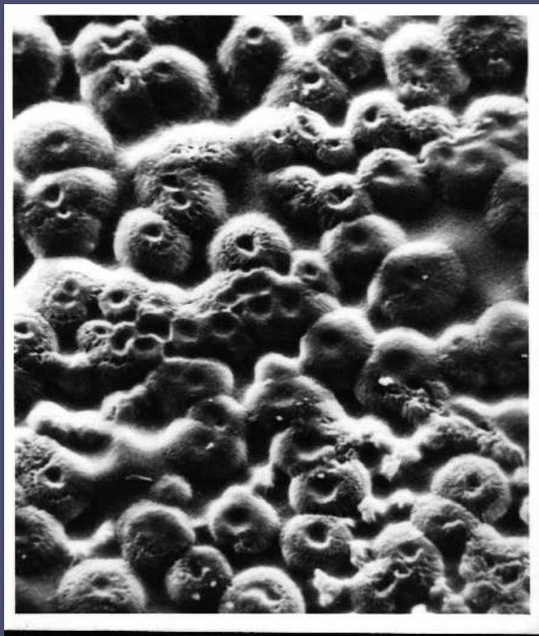
聚乙烯球晶的电子扫描电镜照片。右图是局部放大的照片。
