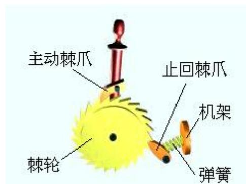
**工作原理：**主动摆杆逆时针摆动时，摆杆上铰接的主动棘爪插入棘轮的齿内，推动棘轮同向转动一定角度。当主动摆杆顺时针摆动时，止回棘爪阻止棘轮反向转动，此时主动棘爪在棘轮的齿背上滑回原位，棘轮静止不动。此机构将主动件的往复摆动转换为从动棘轮的单向间歇转动。利用弹簧使棘爪紧压齿面，保证止回棘爪工作可靠。
