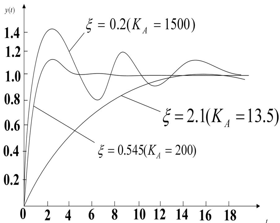
$K_A$  增大， $t_p$  减小， $t_r$  减小，可以提高响应的快速性但超调量也随之增加，仅靠调节放大器的增益，难以兼顾系统的快速性和平稳性。
