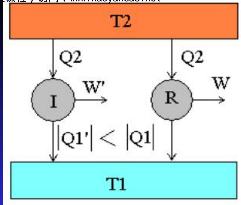
卡诺机 R 的效率大，则同样从热库  $T_2$  吸取热量  $Q_2$ ，热机 I 所作的  $W'$  将大于卡诺机 R 所作的功  $W$ ，即  $W' > W$ ，或表达成：
