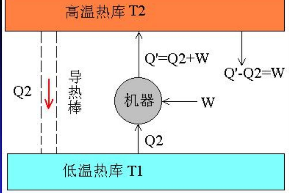
· 此机器就可以从热库  $T_1$  取出  $Q_2$  的热量，并有  $Q'$  的热量送到热库  $T_2$ ，根据热力学第一定律（能量守恒）：
