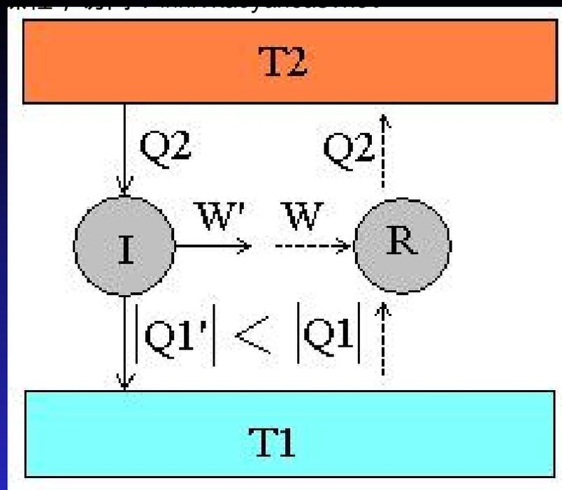
得到  $W$  的功时就可从热库  $T_1$  吸取  $|Q_1|$  的热量，同时有  $Q_2$  的热量流入热库  $T_2$  (用虚线表示卡诺机反转，制冷机)。
