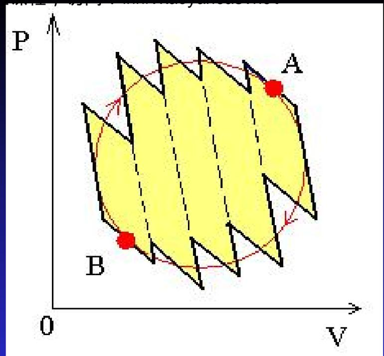
所表示的绝热过程的热温商为零。因此，曲折线循环过程的热温商之和等于它所构成的这些（图中有5个）微可逆卡诺循环的热温商之和。
