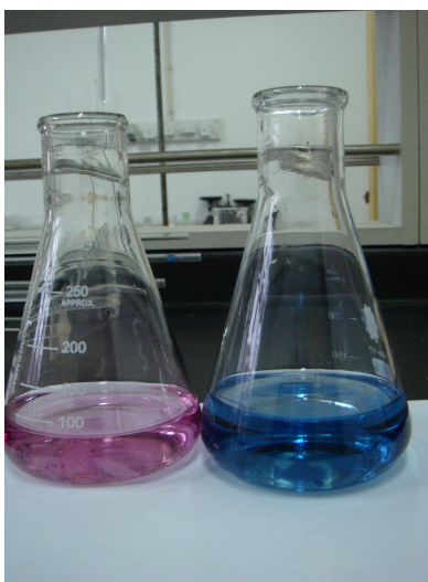
图 5-5 EDTA 滴定钙时指示剂颜色变化
