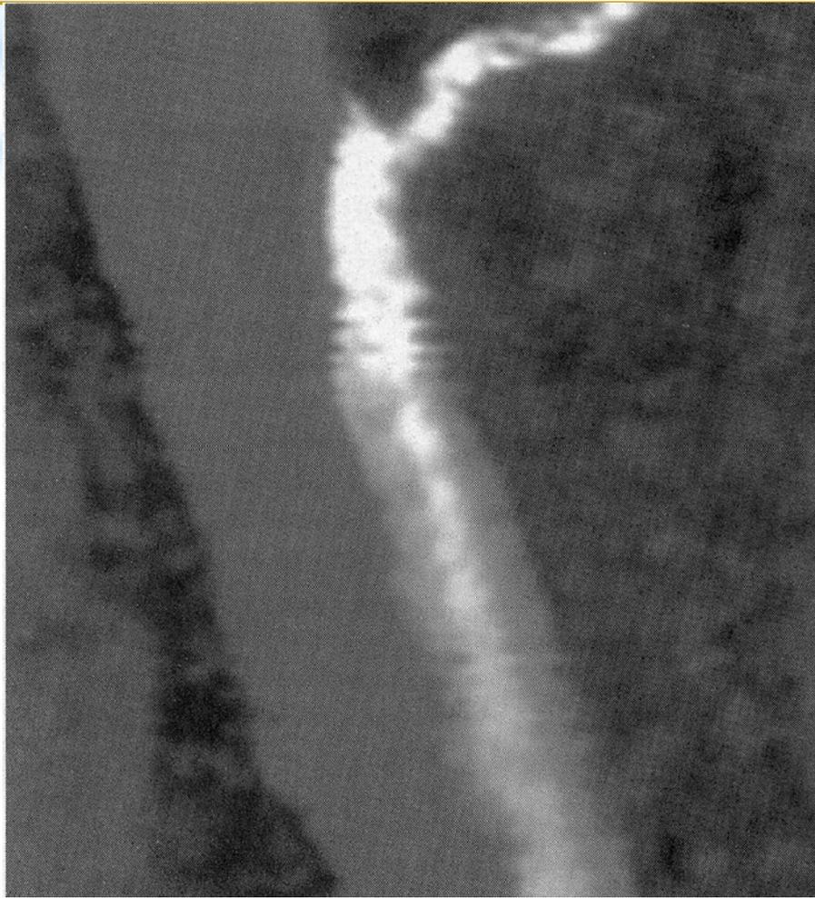
图12-3 利用热红外（8.0~14um）遥感技术监测出河流中的污染源和河流污染状况
