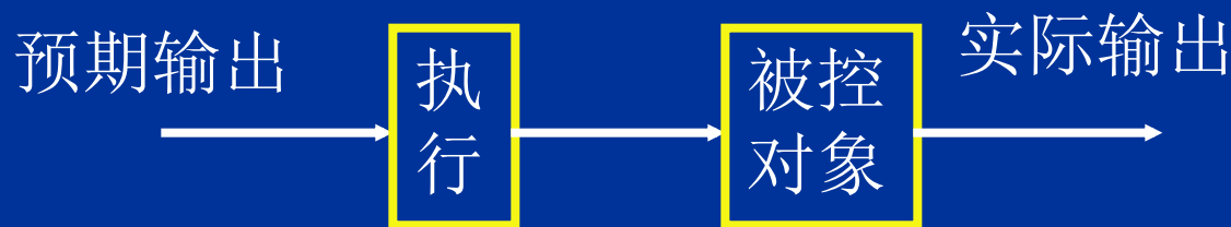
图1.2 开环控制系统 (无反馈)
