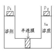
了维持两边的液面高度相等,必须给溶液的一方的液面施加一定的压力,这个压力称为渗透压。
